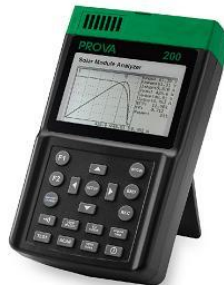
Şekil 3. 4. Fotovoltaik panel analiz cihazı
