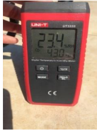
Şekil 3. 6. Sıcaklık ve Nem Ölçer
