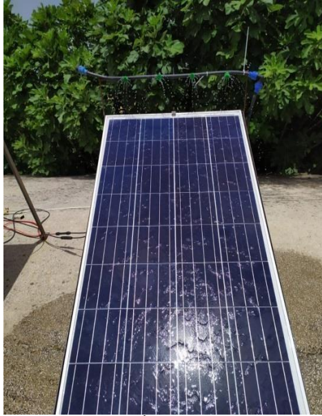
Şekil 2.14. Su İle Soğutma Sistemi
