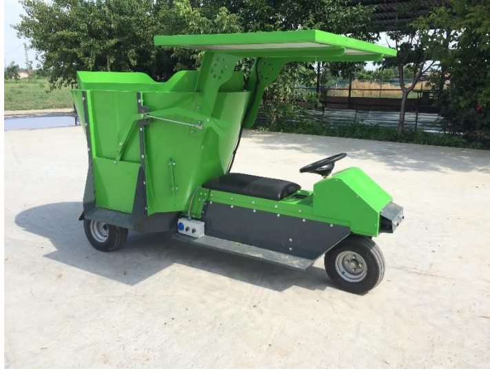
Şekil 4.2. İmalatı tamamlanmış güneş enerjisi destekli elektrikli yem karma makinesi
