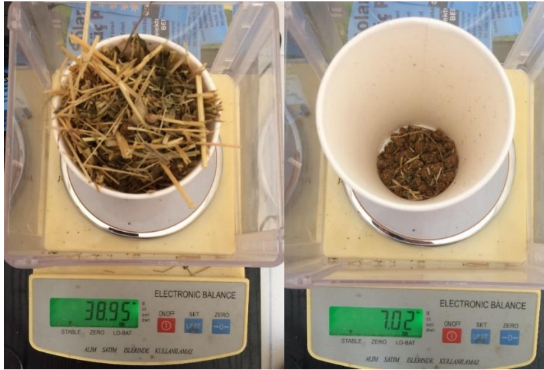
Şekil 4.5. Karma işlemi yapılmış numuneler ve içindeki palet yem düzeyi Güneş enerjisi destekli elektrikli yem karma makinasında yapılan karma işlemi sonucunda elde edilen yemlerin palet yem içeriği ve oranına ait dağılım Çizelge 4.5’de verildiği gibidir.
