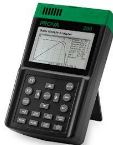
Şekil 3. 4. Fotovoltaik panel analiz cihazı
