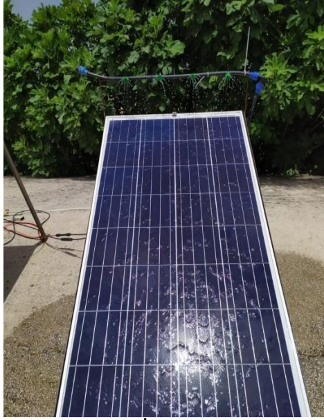
Şekil 2.14. Su İle Soğutma Sistemi
